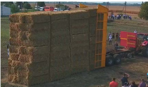
Żaładunek i transport sнопków bez angażowania dodatkowego sprzętu
