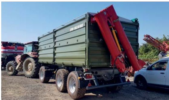
Tylna ściana przystosowana do ślimaka przeładunkowego
