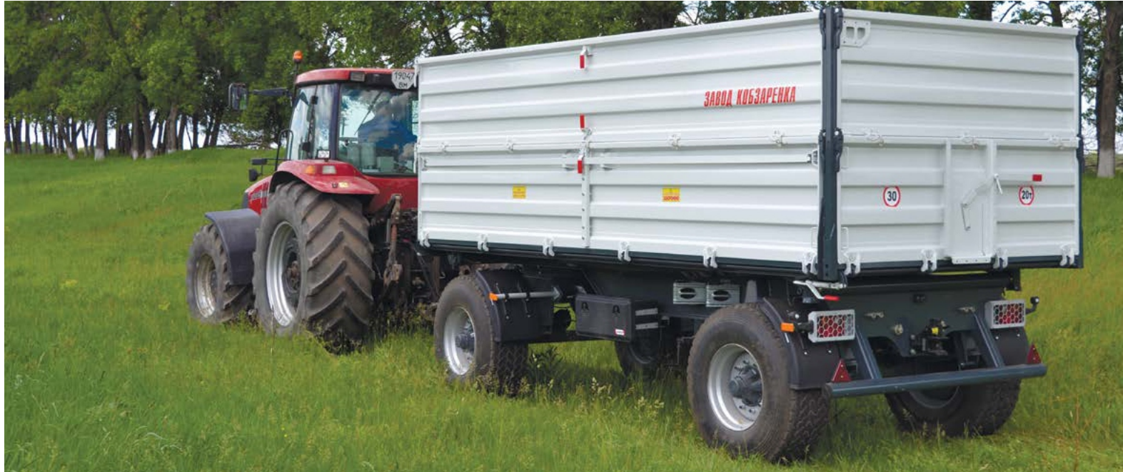
Przyczepy wywrotki łatwo przekształcają się w zwykłą platformę.
