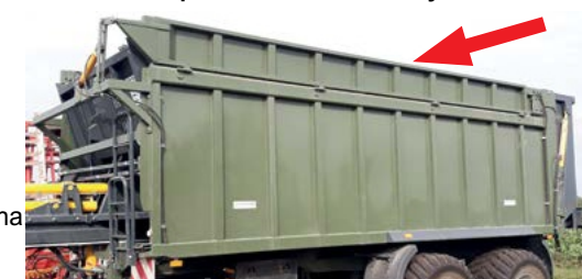
Hydraulicznie otwierana boczna burta -400 mm
