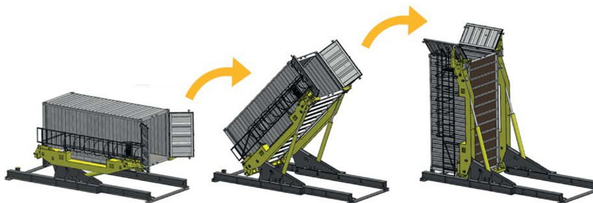
Proces przygotowania kontenera do załadunku
