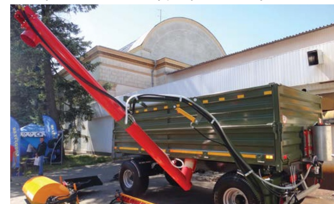
Boczny podajnik ślimakowy NBSH-250/4
