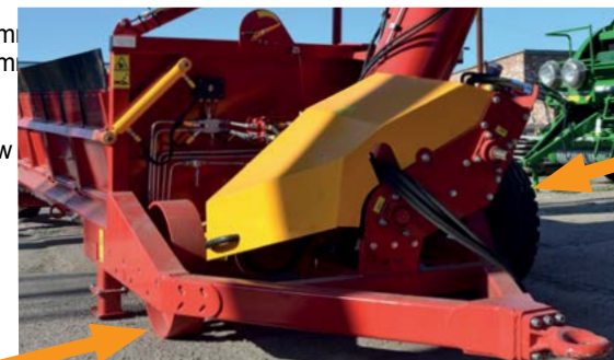
Dodatkowe przednie koła podporowe służą do przemieszczania kontenera wraz ze zbożem
