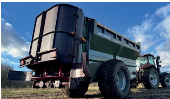
Tylna burta otwierana hydraulicznie
