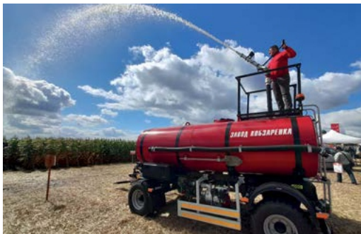
Beczka strażacka PC-6 V-6 m Podawanie cieczy przez armatkę na odległość do 30m. Wypożyczenie z pompą zasila od WOM ciągnika lub motopompą.
