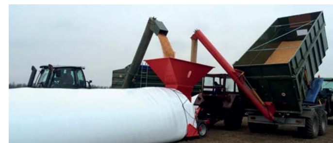
Hydraulicznie rozkładany podajnik ślimakowy GRSH-300/4,5
