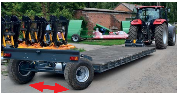
Platforma niskopodwoziowa NP-7 - ładowność – 7 t.
