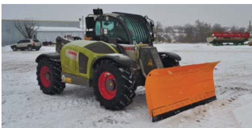
Pług do śniegu do ładowarki teleskopowej VS-2400
