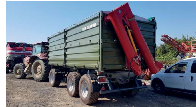
Montaż ślimaków do przyczep ciągnikowych
