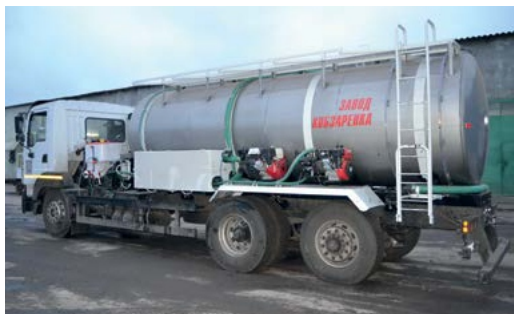
Montaż RZS na podwoziu samochodów ciężarowych
