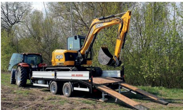
Przyczepa do transportu sprzętu specjalistycznego do 9 ton.
