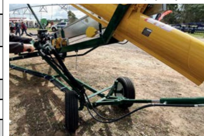
Mechanizm manewrowania tylnymi kołami
