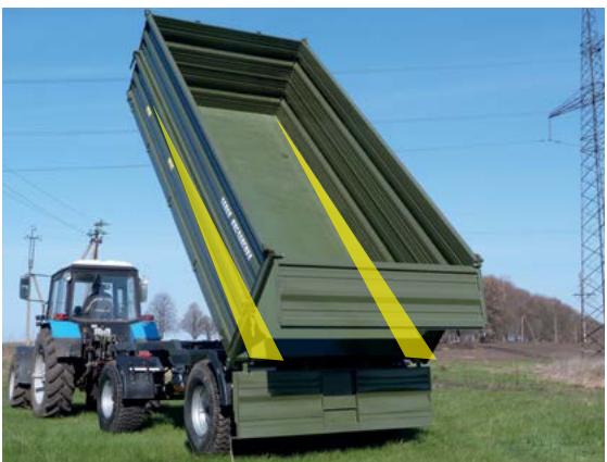
Stożkowy kształt skrzyni ładunkowej zapobiega zawieszaniu się ładunku
