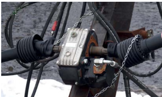
Własna hydraulika w celu zwiększenia przepływu oleju.
