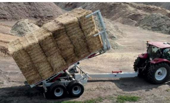
Rozładunek przyczepy do kostki na płaskiej i twardej powierzchni zajmuje 30-40 sekund
